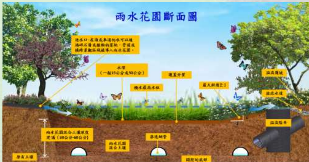
圖3-13 花園土壤雨水截留構造示意圖
