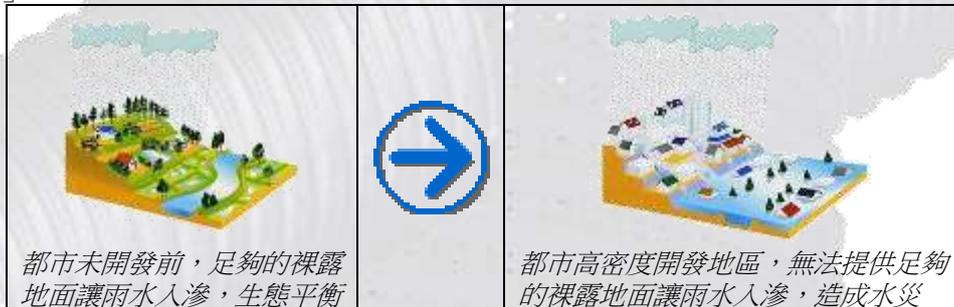
下圖中結果可明顯看出，原始的自然地表覆蓋率改變成75%~100%的不滲透表面時，隨著不滲透區域面積的擴大，原有的自然地表逕流機制也隨之產生重大變化，原本只佔總降雨量10%的逕流量因都市化的結果暴增至總降雨量的55%，而入滲比率則由原先總降雨量的50%減為只有15%，並使蒸發量也隨之降低。由此一地區都市化之變化結果，我們可以很清楚的看到，因都市化所造成的地表逕流、蒸發與入滲三者間之水文循環變化關係所造成的城鄉水環境變化。
