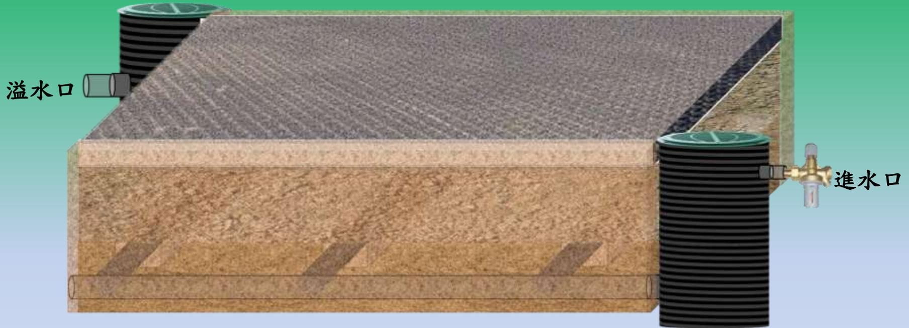
(十一) 在連PGG鎖植草格的凹植槽內撒上細碎石級配沃土並用掃帚均勻掃入PGG連鎖植草格孔內，土層高度以低於連鎖植草格平面5-10mm為基準。
