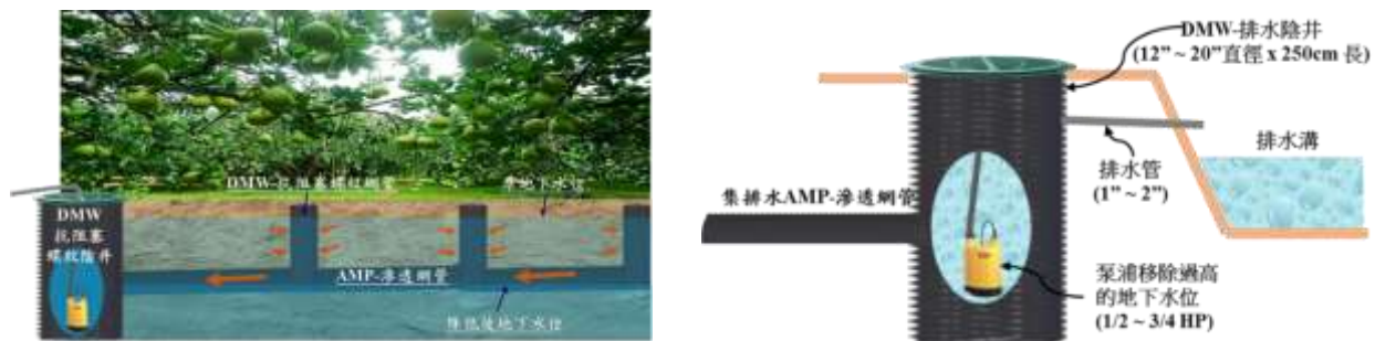
圖 3. 人工排水對排水不良的農田的土壤水管理。
