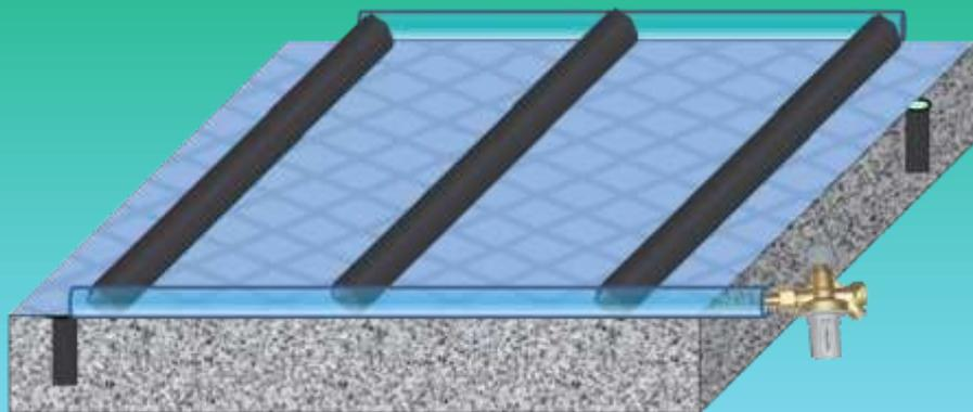
5. 鋪設進水管與AMP-滲透網管
