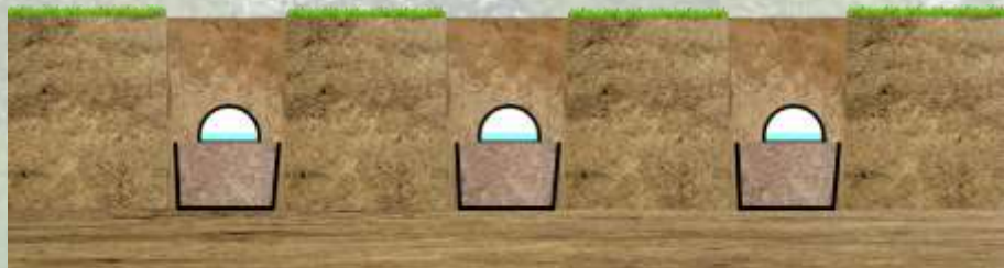
6. 溝渠內回填土填滿
