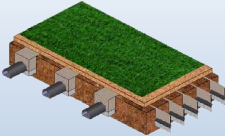
AMPS-運動場灌溉排水
